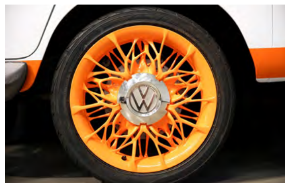
SLS-Teile können zum Erzielen einer metallischen Oberfläche galvanisiert werden.
